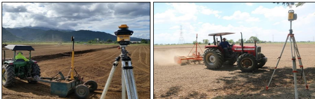
Fig. 15. Laser land levelling
